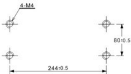
水平和立面安装定位孔
